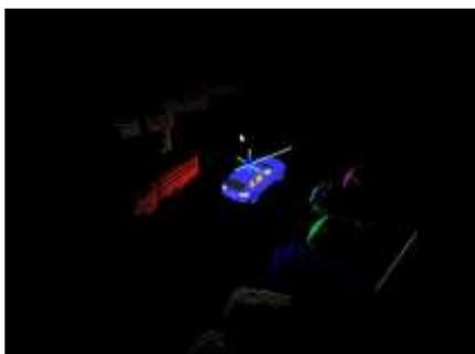
Figura 3. Exemplo de uma nuvem de pontos 3D após sua segmentação. Os pontos associados a diferentes agrupamentos (ou segmentos), que representam diferentes objetos no ambiente, são destacados por cores diferentes
