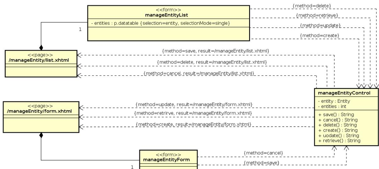
Figura 3 – Modelo de Navegação de um CRUD `nemo-utils`, usado como base para funcionalidades dos cadastros do sistema SAE (LIMA, 2015).
