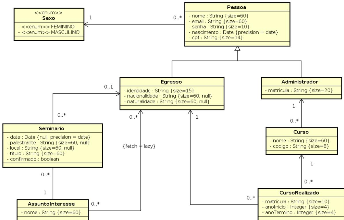
Figura 6 – Modelo de Domínio do SAE para o módulo *sae.core*.
