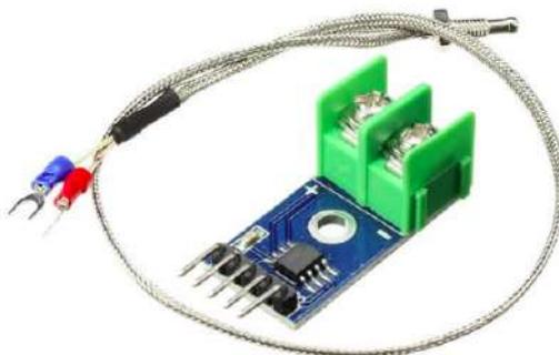
Figura 13 – Max6675 e termopar tipo K
