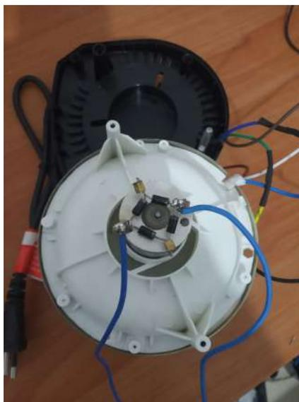
Figura 21 – Ligação dos fios para o motor DC
