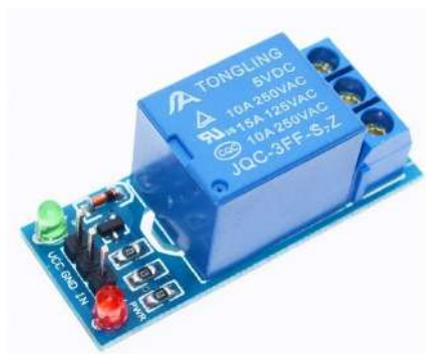
Figura 14 – Relé eletromecânico
