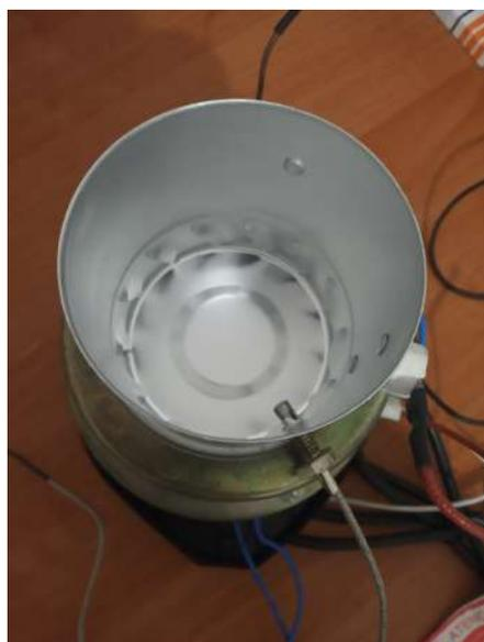
Figura 22 – Furo de acoplamento do sensor de Temperatura
