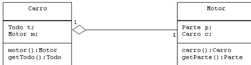
**Figura 4.22 - Relação de agregação entre um objeto Carro e seu Motor como uma relação binária com papéis**
